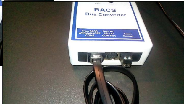
... COM3-Schnittstelle am BACS-Bus Converter
