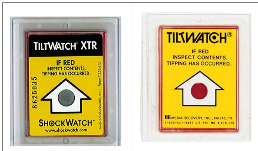
Abbildung 2: TiltWatch-Aufkleber: links i.O. / rechts nach Umkippen
